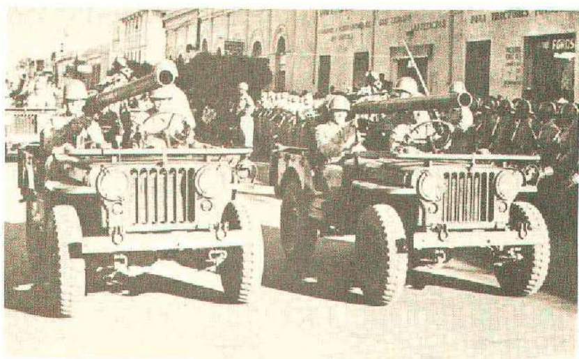
Cañón sin retroceso, cal. 106 mm., montado en Jeep Willys 1/4 Ton.
